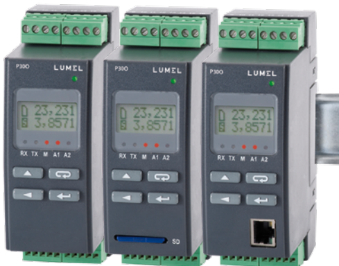
Rys.1. Wygląd przetwornika P300 w różnych wykonaniach.
